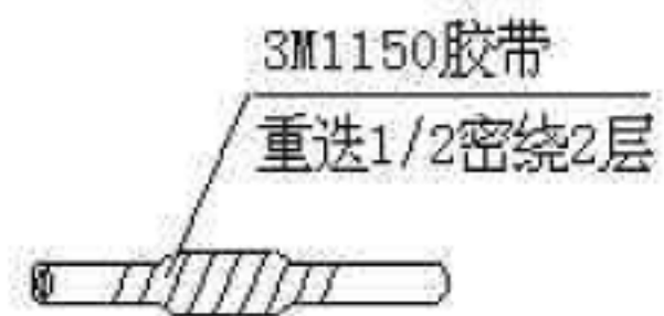
线管粘合后的防水处理
